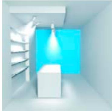
Apparecchi illuminanti posti direttamente sopra la cassa garantiranno un buon illuminamento orizzontale del piano di lavoro. L'illuminazione di superfici verticali dietro la cassa permette ai clienti di identificare meglio la sua posizione e funziona come mezzo di comunicazione aziendale con i clienti in attesa.
