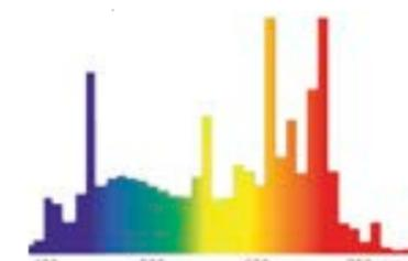
• **il tubo fluorescente (77)** emette luce con le parti dello spettro rosse e blu amplificate, adatte ai processi fotobiologici delle piante. E' utilizzato in luoghi con insufficiente luce naturale. Le principali aree di applicazione sono i negozi di fiori e negozi di acquari.
