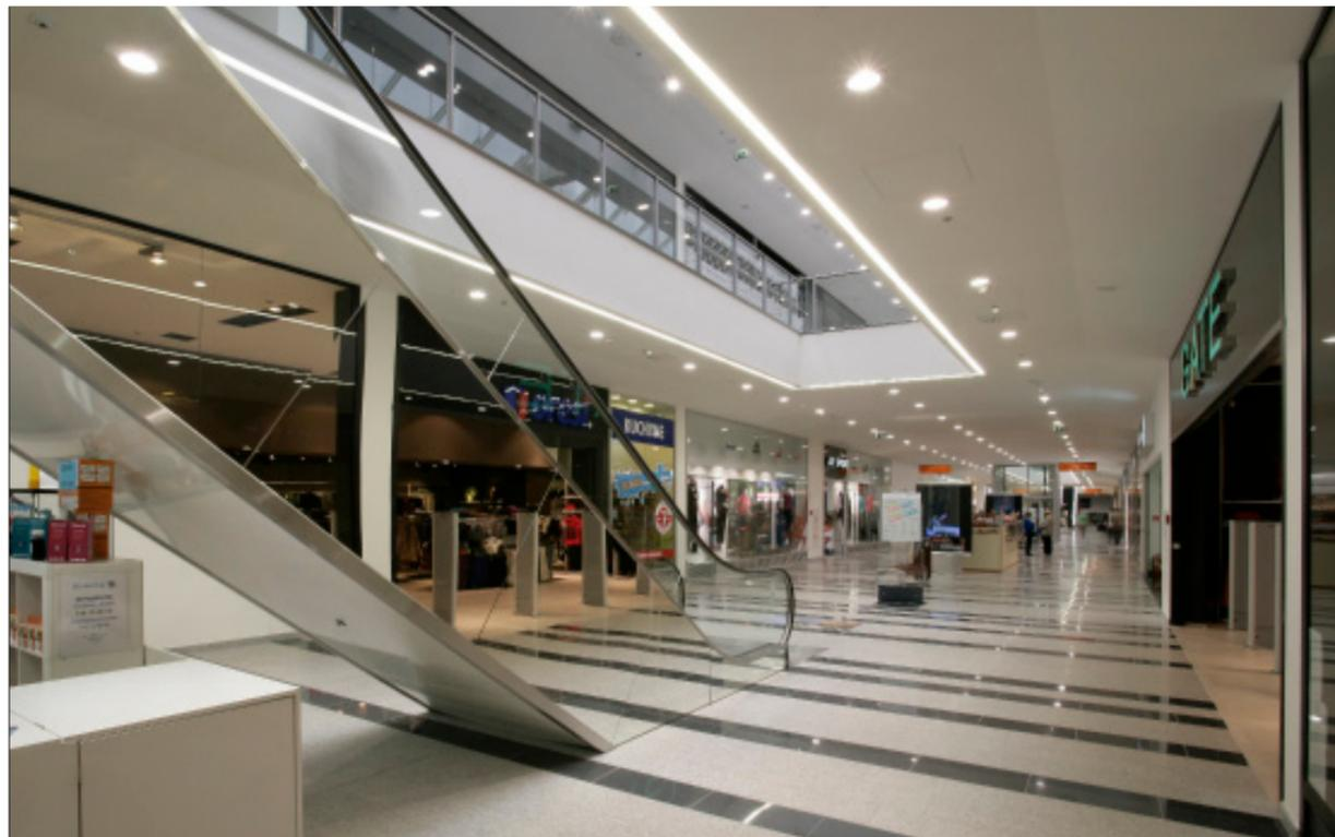
Gli apparecchi illuminanti a soffitto sono frequentemente utilizzati nei corridoi all'interno dei centri commerciali. La linea continua di luce allarga otticamente lo spazio del corridoio e crea un'atmosfera accogliente. Eleganti apparecchi illuminanti a sospensione posti nella linea centrale orientano il flusso luminoso verso il basso e illuminano il corridoio indirettamente riflettendo la luce dal soffitto.
