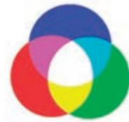
Beim RGB-Prinzip wird das Farbspektrum durch Mischen dreier Grundfarben des Lichts gebildet. Abgekürzt steht RGB für Rot, Grün und Blau. Bei gleicher Stärke aller drei Farben entsteht Weiß. Alle sonstigen Farben erhalten wir durch die Änderung des Mischungsverhältnisses von R, G und B.
