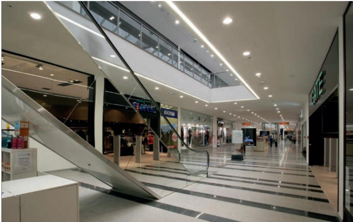
Die Beleuchtung abgehängter Decken ist eine oft benutzte Art der Beleuchtung von Verbindungsrouten in Einkaufszentren. Die ununterbrochene Lichtlinie vergrößert optisch den Raum des Gangs und kreiert eine verlockende Atmosphäre. Stilvolle Hängeleuchten in der mittleren Linie orientieren den Lichtstrom nach unten und beleuchten über Reflexionen von der Decke indirekt den Gang.
