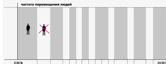
**Скачкообразное регулирование:** при обнаружении присутствия светильники включаются одновременно, только если уровень освещенности ниже предустановленного значения. Если он выше, светильники в помещении остаются выключенными, даже если движение не прекращается. Для данного вида комбинированной системы управления освещением светильники не нуждаются в пускорегулирующем аппарате с регулировкой яркости.
