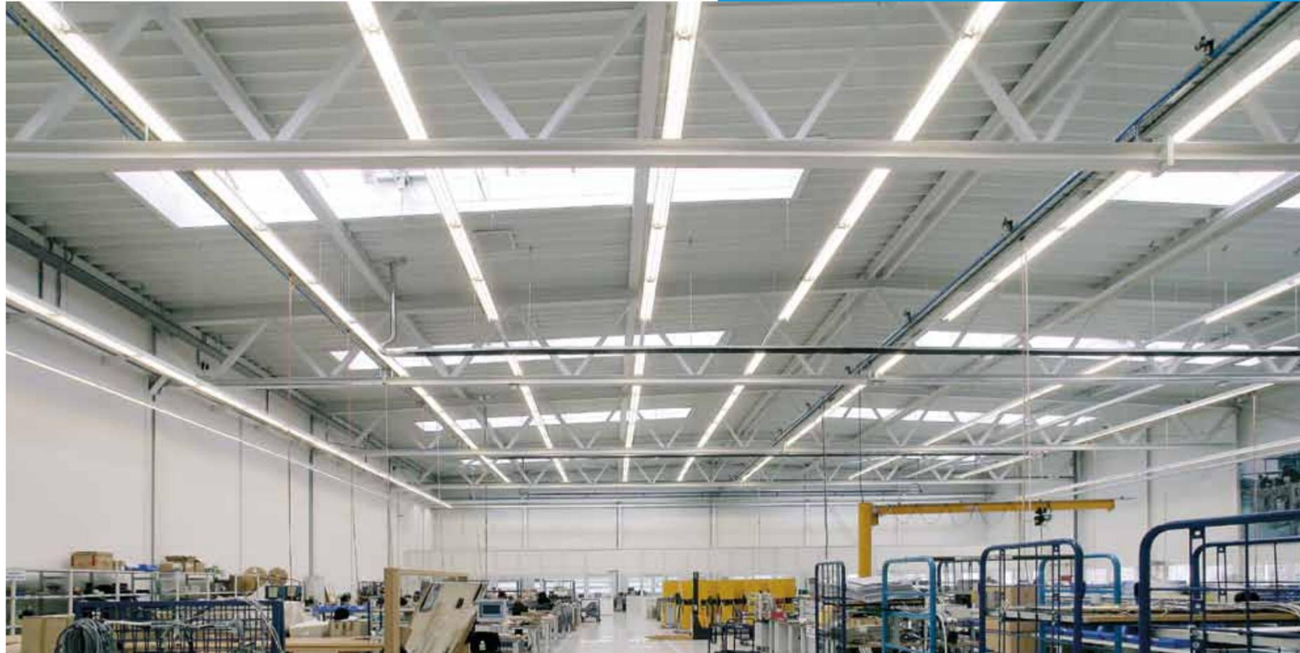
Моделирование дневного света обычно осуществляется при помощи датчика дневного света. Он оценивает интенсивность освещения помещения в течение дня, и, согласно этому, увеличивает или уменьшает мощность светильника в системе освещения. Таким образом, обеспечивается постоянная освещенность пространства в соответствии со стандартом.
