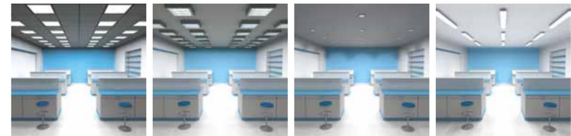
Сбалансированное распределение яркости в пространстве зависит от выбора светильников. При применении светильников с прямым распределением светового потока (Рисунок 1-3) освещенность вертикальных поверхностей может оказаться недостаточной и напоминать «пещеру». Для предотвращения возникновения такого эффекта следует использовать светильники с кривой распределения силы света очень большого радиуса (Рисунок 4).
