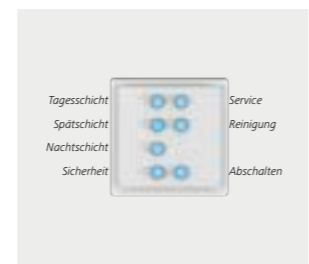
Beschreibung neben den Knöpfen auf dem Control Panel zum Abrufen von Beleuchtungsszenarien.
