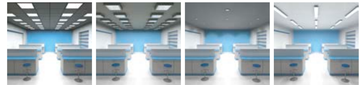
Die harmonische Verteilung der Helligkeit in einem Raum kann durch die Auswahl der Leuchten beeinflusst werden. Wenn wir Leuchten mit direkter Verteilung des Lichtstroms verwenden (Abbildung 1 - 3), erreichen wir keine ausreichende Beleuchtung der vertikalen Oberflächen, was zu einem Höhleneffekt führt. Durch Nutzung von Leuchten mit einer sehr weiten Helligkeitskurve kann eine solche Situation vermieden werden. (Abbildung 4).
