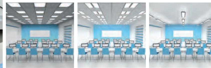
Les luminaires encastrés à grilles- voir la figure 1 - ne fournissent pas suffisamment d'éclairage des surfaces verticales et au plafond. En même temps, ils représentent un risque d'apparition de reflets indésirables sur les écrans en raison de l'éblouissement indirect. Les luminaires encastrés ou suspendus ayant un rayonnement direct et indirect avec une surface mate ou avec des microprismes représentent une solution optimale.
