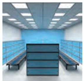
Du point de vue normatif, il n'y a pas d'exigences élevées sur le niveau d'éclairage dans les vestiaires. Cependant, il est important d'assurer un éclairage vertical suffisant des casiers et de créer les conditions appropriées pour la reconnaissance des couleurs.
