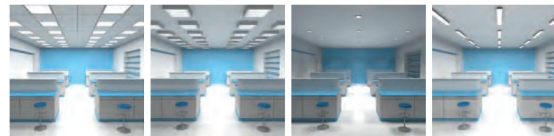
Lors du choix des luminaires pour les laboratoires et les ateliers, il est nécessaire de prendre en compte plusieurs facteurs. Il est préférable d'utiliser des luminaires avec un indice de protection IP 54 ou IP 65 dans ces espaces. Dans les ateliers où il y a un risque plus élevé de blessures, en déplaçant des machines en rotation ou à mouvement alternatif, les luminaires doivent être équipés de ballasts électroniques pour empêcher le risque de l'effet stroboscopique.
