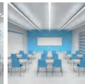
Les luminaires linéaires suspendus avec la caractéristique directe et indirecte du rayonnement assurent l'éclairage requis du plan de travail et un éclairage vertical suffisant des surfaces. Les solutions les plus idéales sont les luminaires qui conduisent 50% du flux lumineux directement au plan de travail et 50% des composants indirects qui sont dirigés vers le plafond.
