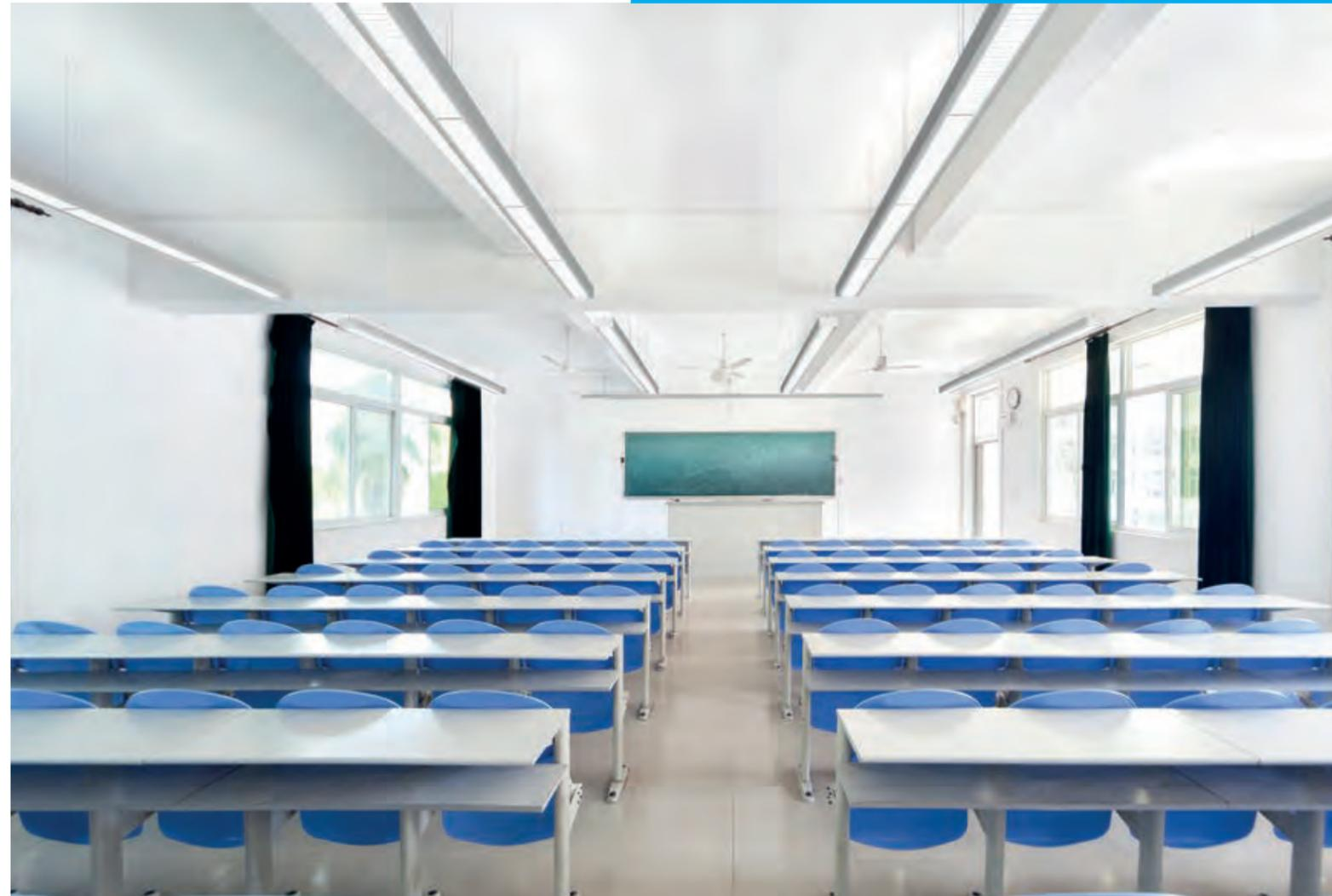
salles de classe ont un mur avec des fenêtres. La disponibilité de la lumière du jour est aussi souhaitable dans ce type d'espace. Par conséquent, la lumière artificielle dans les salles de classe doit être contrôlable pour compléter la lumière du jour lorsque cela est nécessaire. C'est pourquoi l'utilisation du capteur de lumière du jour doit être envisagée. En même temps, il est nécessaire d'éviter les éblouissements indésirables et d'adapter aux fenêtres un système avec des stores ou des
