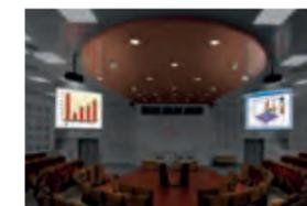
SCÈNE D'ÉCLAIRAGE 3: Lors d'une présentation avec un rétroprojecteur, l'éclairage général est atténué et s'allume à 10%.
