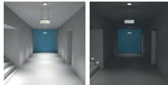
Während des normalen Betriebs erreicht die Beleuchtungsstärke das vorgeschriebene Niveau. Während eines Stromausfalls oder bei einem Brand, sorgt die Notbeleuchtung für die Sichtbarkeit und Orientierung der Menschen beim Verlassen des Raumes oder erleichtert den Zugang zu den Feuerlöschern.
