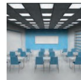
Deckeneinbauleuchten mit Raster mit direkter Distributionscharakteristik des Lichtstroms sind nicht für Klassenzimmer geeignet. Denn mit ihnen wird die Decke nicht ausreichend beleuchtet.
