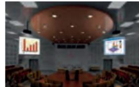
BELEUCHTUNGSSZENE 3: Während einer Präsentation mit Overhead-Projektor wird die Hauptbeleuchtung abgedimmt und die Leuchten sind auf 10 % eingestellt.
