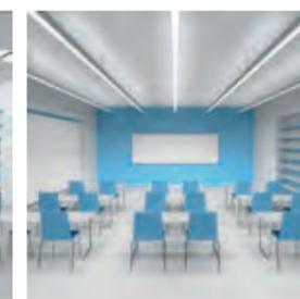
Lineare hängende Leuchten mit direkter und indirekter Lichtemission sorgen für die erforderliche Beleuchtung der Arbeitsebene und die ausreichende vertikale Beleuchtung der Flächen. Leuchten, die 50 % des Lichtstroms direkt auf die Arbeitsebene und 50 % der indirekten Komponenten an die Decke richten, stellen die idealste Lösung dar.
