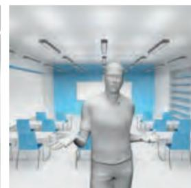
Zur korrekten Modellierung von Gesichtern ist es wichtig, für eine ausreichende zylindrische Lichtstärke von 150 Lux in Klassenzimmern zu sorgen. Hängende Leuchten mit direkter und indirekter Distributionscharakteristik des Lichtstroms, die die Bildung unerwünschter Schatten eliminieren und gleichzeitig keine Blendung verursachen, stellen eine optimale Lösung dar.
