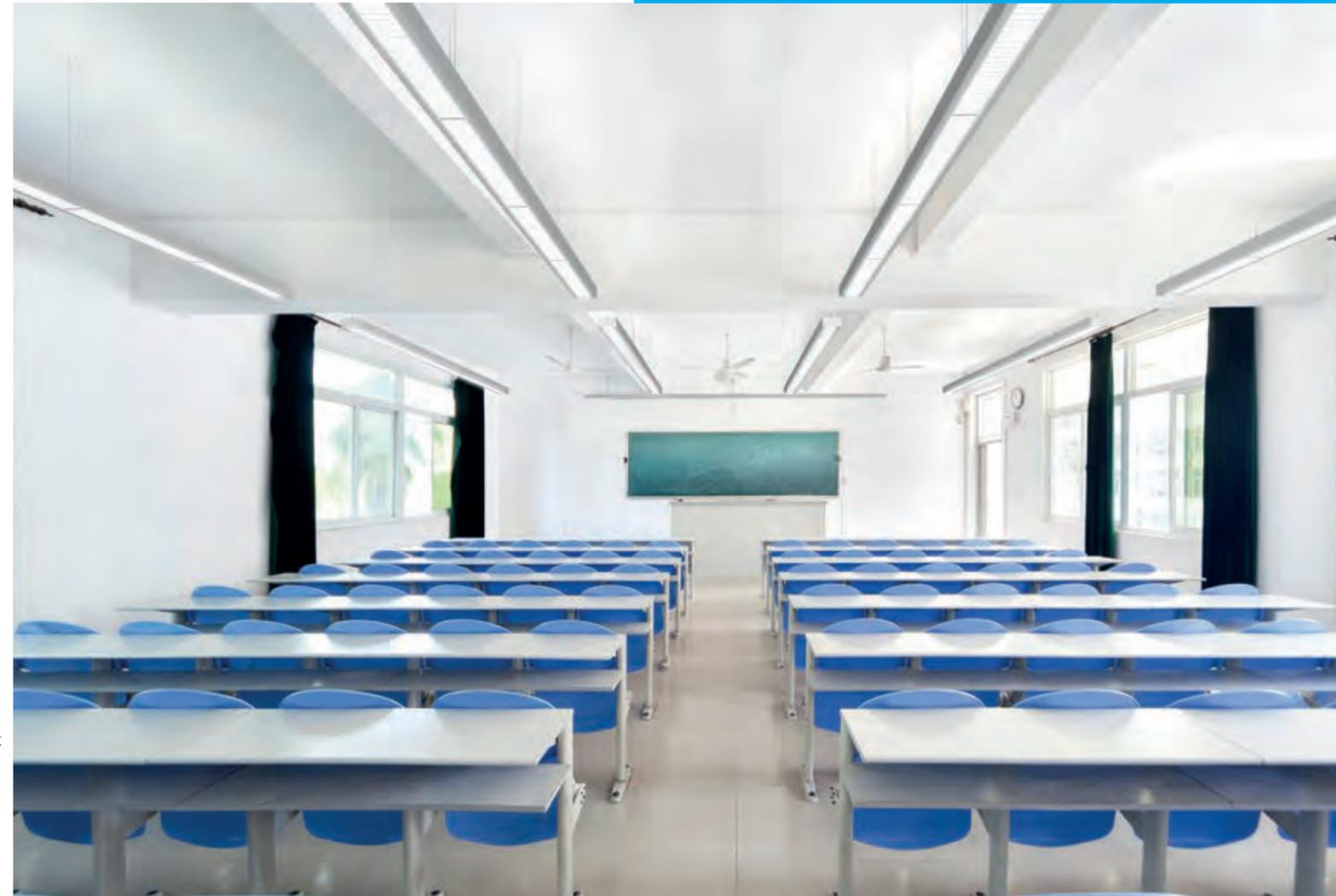
Unterschiede in der Helligkeitsintensität zu schaffen. In fast allen Klassenräumen befindet sich eine Wand mit Fenstern. Die Verfügbarkeit von Tageslicht ist in dieser Art von Raum auch wünschenswert. Folglich sollte das künstliche Licht in Klassenräumen so gesteuert werden können, dass es bei Bedarf das Tageslicht ergänzt. Deshalb sollte der Einsatz eines Tageslichtsensors in Erwägung gezogen werden. Gleichzeitig ist es notwendig, eine unerwünschte Blendung zu vermeiden und
