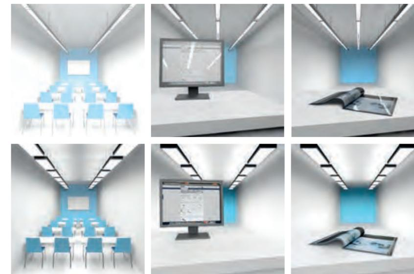
**Direktblendung** wird durch eine übermäßige Leuchtdichte verursacht, wie zum Beispiel durch nicht richtig positionierte oder freistrahkende Leuchten. Sie ruft ein psychologisches und visuelles Gefühl des Unwohlseins hervor. Deshalb ist es unerlässlich, die Direktblendung auf ein Minimum zu reduzieren. Leuchten mit Mikroprisma stellen beispielsweise eine geeignete Lösung dar.
