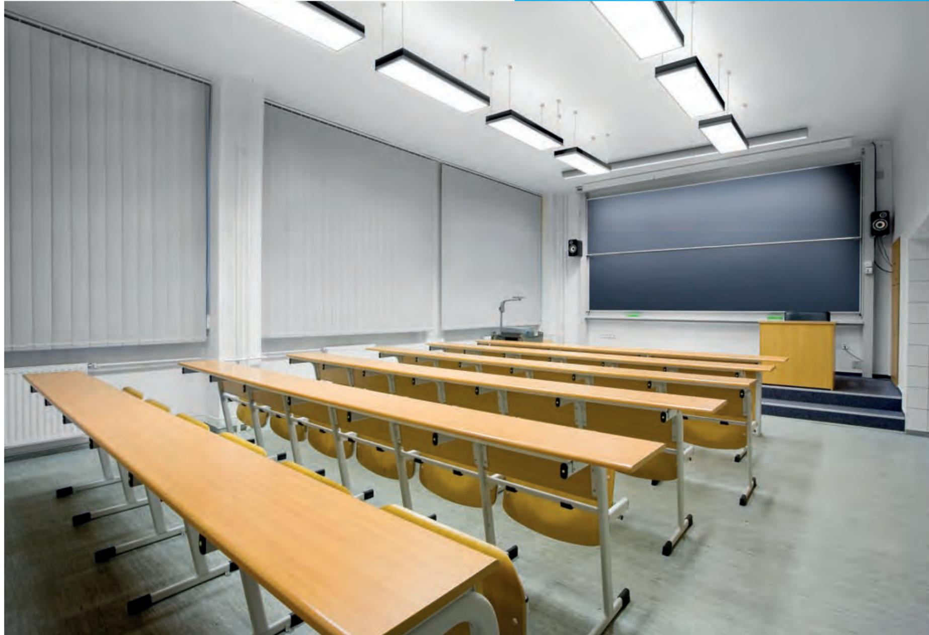
Die hängende Leuchte MODUL BOX MAX mit direkten und indirekten Lichtstromeigenschaften stellt eine optimale Lösung für die Beleuchtung in Klassenräumen dar. Die direkte Komponente, die direkt auf den Aufgabenbereich gerichtet wird, gewährleistet ein ausreichendes Beleuchtungsniveau. Die indirekte Komponente des an die Decke gerichteten Lichts beleuchtet ausreichend die Decke und die vertikalen Flächen.
