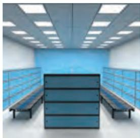
Aus normativer Sicht bestehen keine hohen Anforderungen an die Beleuchtungsstärke in den Umkleieräumen. Es ist jedoch wichtig, eine ausreichende vertikale Beleuchtung der Schließfächer sicherzustellen und Voraussetzungen zum korrekten Erkennen von Farben zu schaffen.
