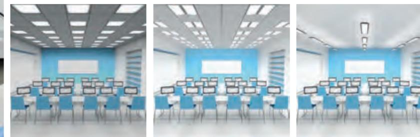
Deckeneinbauleuchten mit Raster (siehe Abbildung 1) bieten keine ausreichende Beleuchtung der vertikalen Flächen und der Decke. Gleichzeitig bergen sie das Risiko unerwünschter Reflexionen auf den Bildschirmen aufgrund von Reflexblendung. Deckeneinbauleuchten oder hängende Leuchten mit direkter und indirekter Strahlungscharakteristik mit matter Oberfläche oder mit Mikroprisma stellen eine optimale Lösung dar.
