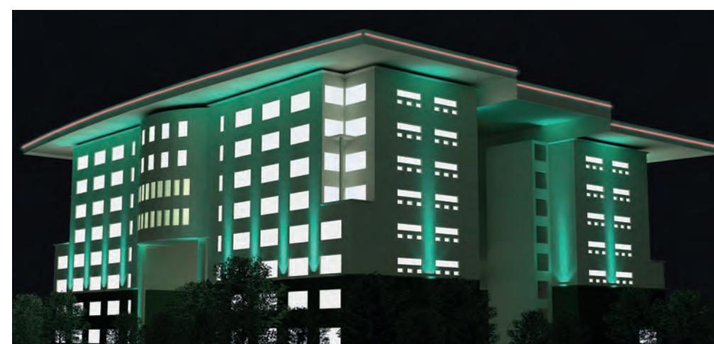
Budova nasvetlená „wall washing“ efektom a doplnená o líniové obrysové osvetlenie rímsy v oblasti strechy budovy. Ovládanie je vykonávané z centrálného dotykového panelu.
