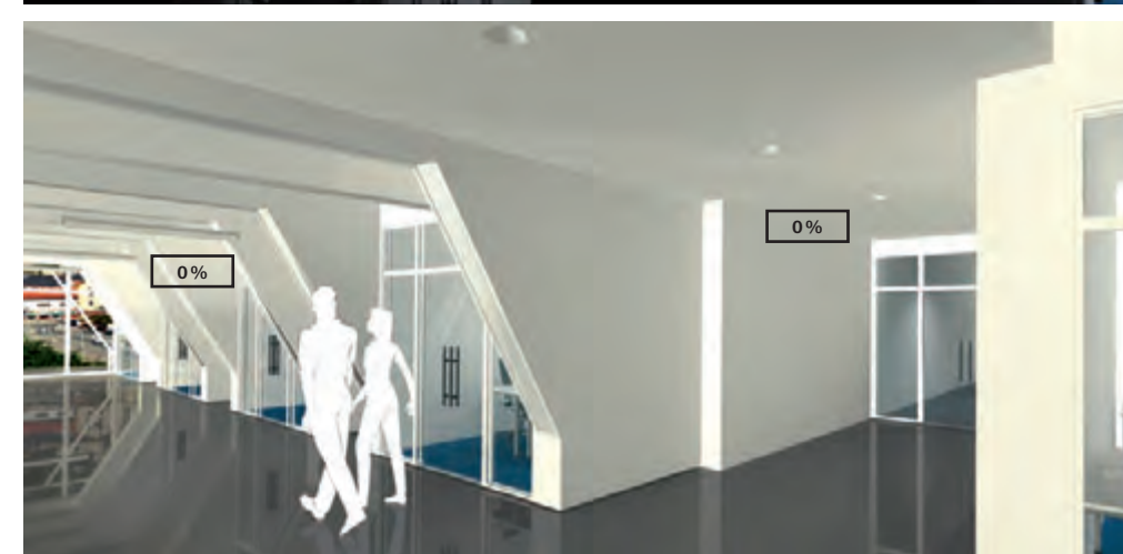
Ak je priestor počas dňa dostatočne presvetlený slnečným žiarením a hladina osvetlenosti dosahuje úroveň nad prednastavenú hodnotu spínania, svietidlá v oboch zónach sa nerozsvietia aj napriek tomu, že je detekovaný pohyb.
