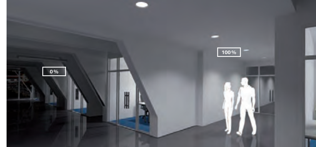
Ak je pohyb detekovaný len v prvom sektore, svietidlá svietia len v ňom.
