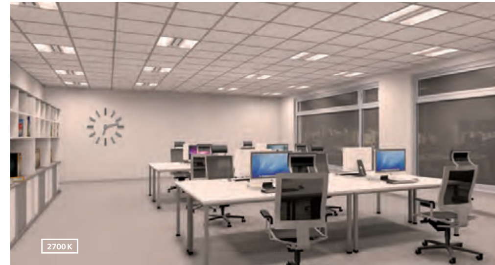
Zmena náhradnej teploty chromatickosti sa vykonáva automaticky, podľa prednastavenej logiky. V danom priestore je aktuálna náhradná teplota chromatickosti bieleho svetla 2700K.
