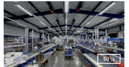
Servis: 50% – svetelný tok 275lx – intenzita osvetlenia 2820W – aktuálna spotreba elektrickej energie
